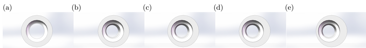
Fig. 2. Different eccentricity models: (a) eccentricity 0%; (b) eccentricity 10%; (c) eccentricity 20%; (d) eccentricity 30%; (e) eccentricity 40%.
